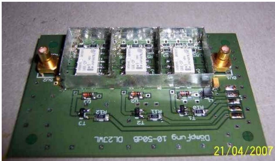
Für den Eingang sowie den Ausgang werden BNC - Buchsen in Crimpausführung für das Kabel RG174 gewählt. Als Verbindungsleitung zu den anderen Leiterplatten wird ebenfalls RG174 Kabel verwendet. Hier sind auch andere Kabel denkbar. Die Anschlussbuchsen werden nicht bestückt. Stattdessen habe ich hier die Kabel direkt auf die Anschlüsse gelötet, dadurch wird ein kompakter Aufbau der Baugruppe ermöglicht.
