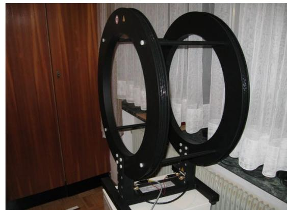
Stimmt man die Antenne auf die Empfangsfrequenz ab, erhöht sich durch die Resonanzhöhung die Empfangsspannung merklich. Die Antenne wird gleichzeitig selektiver. Trotz vorhandener Bedämpfung des Schwingkreises durch das Kabel und den Eingangswiderstand der Soundkarte ist der Zugewinn
